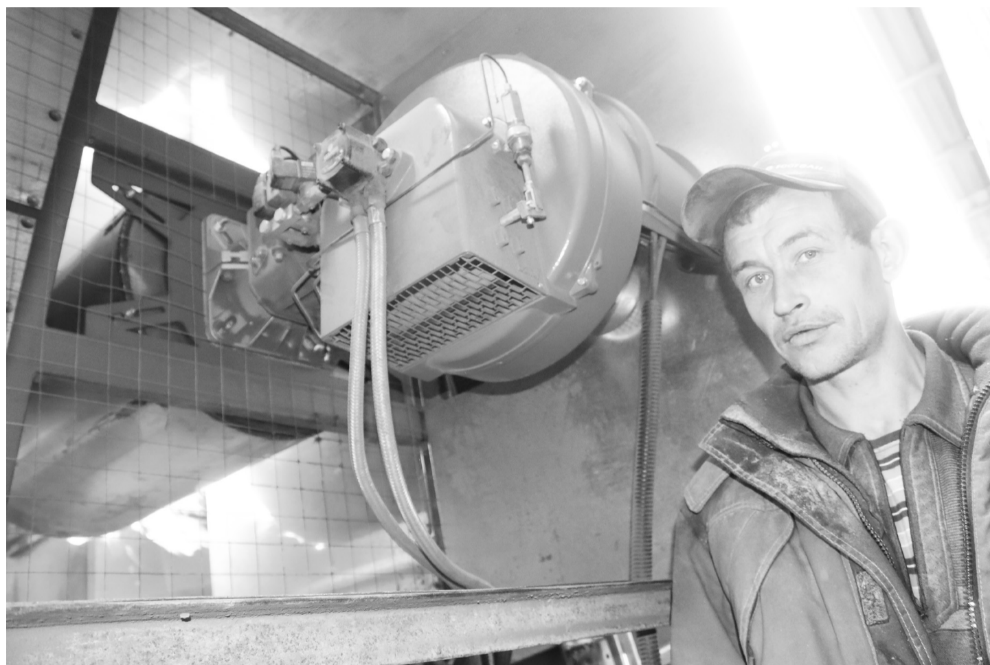
Евгений Метелев показал, как выглядит сушилка. Внутри сверкает пламя, которое нагревает зерно до требуемой температуры.
