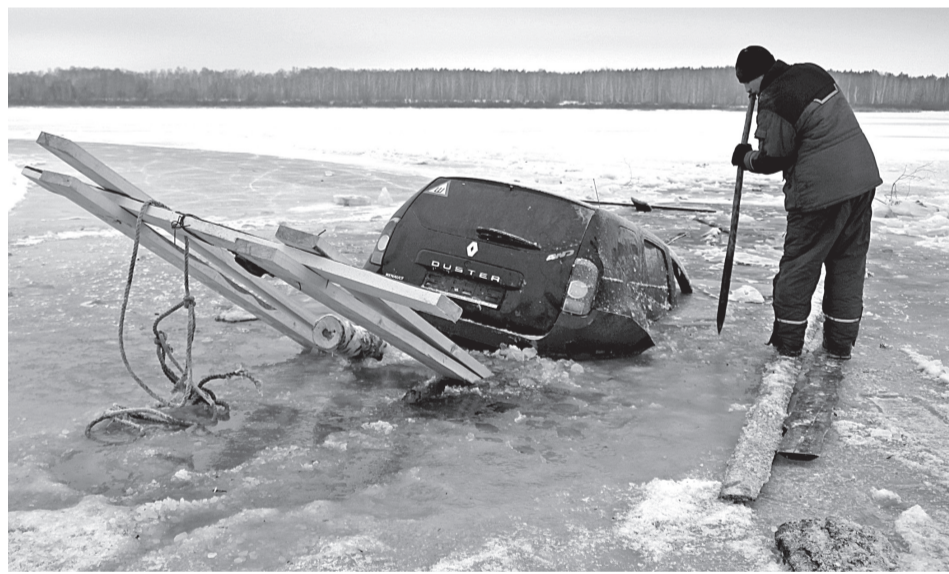
• Только на третий день после установки трапа из кубометра пиломатериала, с помощью троса длиной более сотни метров и грузовика с мощной лебёдкой хозяину провалившегося под лёд «Дастера» удалось выволочь авто из ледяных оков озера в Новолыбаево.
